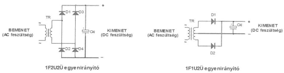
2. ábra: Kimeneti egyfázisú egyenirányító topológiák
