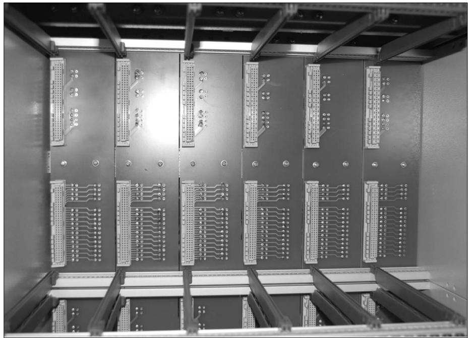
3. ábra. Üres kártyafiók a csatlakozókkal
