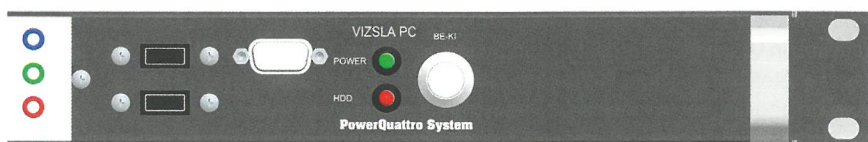
2. ábra: VIZSLA-PC rack előlap részlete
